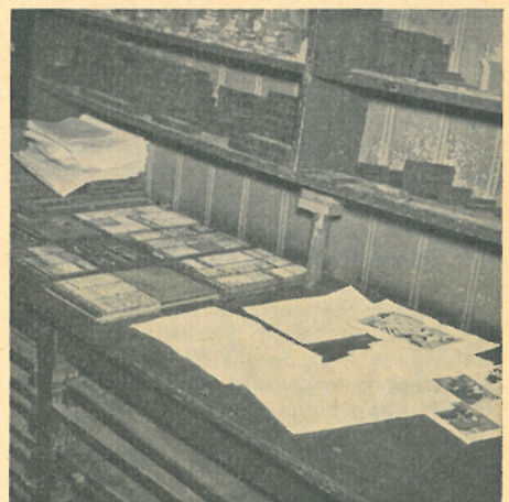
Der Metteurtisch mit unseren „liegenden Blättern“ und dem bereits umbrochenen Hand- und Maschinensatz in Seitenform
