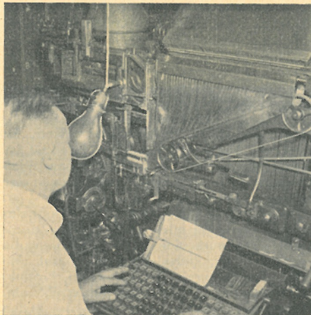
Die Setzmaschine mit der schreibmaschinenartigen Tastatur. Der Setzer hat gerade eine Zeile tertig und „schickt sie ab.“ Bilder (4): H. B. Solbach
